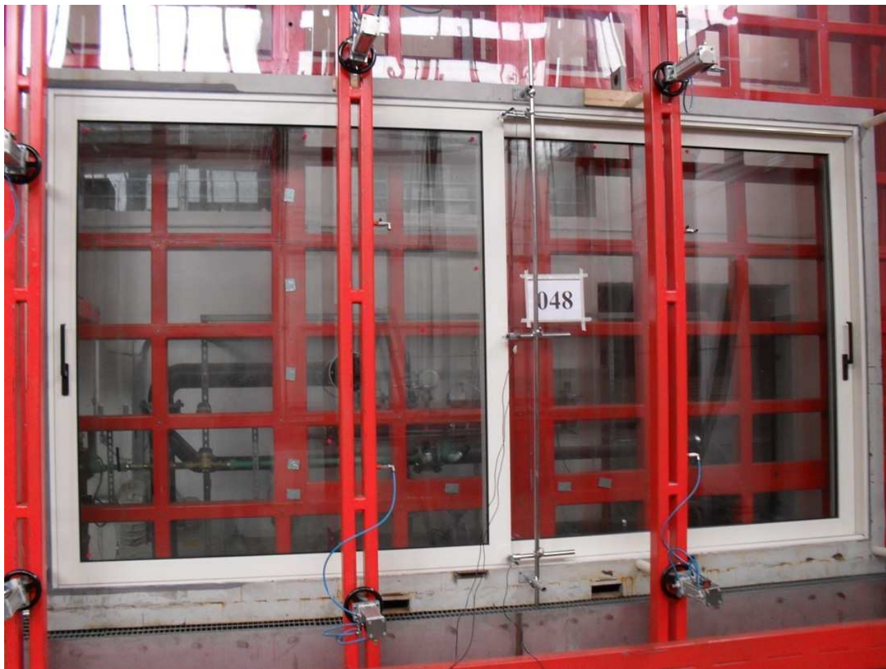
Foto 2: Campione sottoposto a prova durante i test di resistenza al carico del vento (prova di deformazione a pressioni positive e negative)
