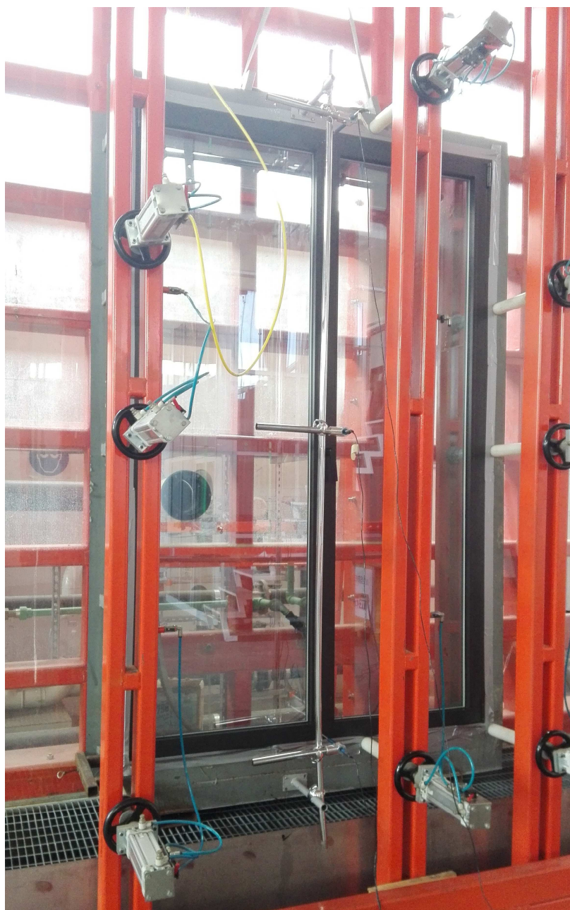
Foto 1. Campione sottoposto a prova nell'assetto sperimentale durante i test di resistenza al carico del vento (prova di deformazione)
