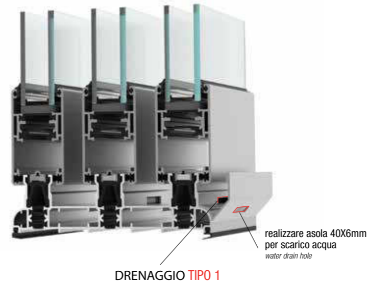
PARTICOLARE CON DRENAGGIO SU GUIDA ZANZARIERA SL 20821 DETAIL WITH DRAIN ON THE MOSQUITO NET GUIDE SL20821
