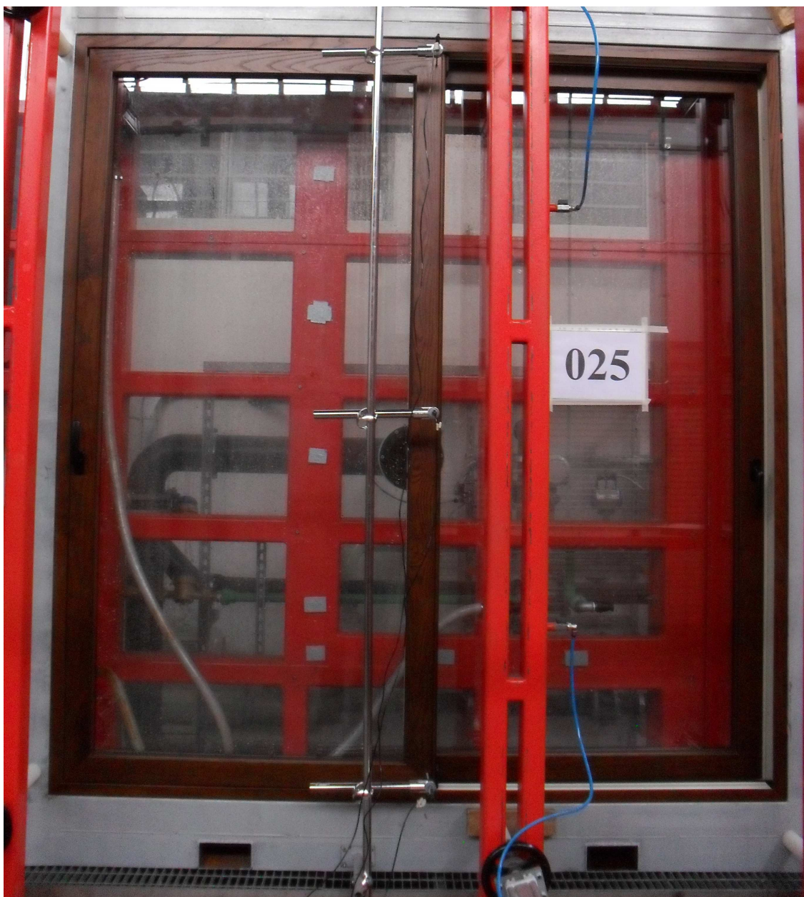
Foto 2: Campione sottoposto a prova durante i test di resistenza al carico del vento (prova di deformazione a pressioni positive e negative)
