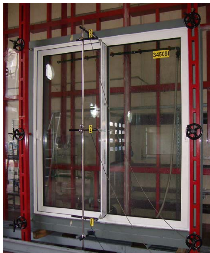
Foto 2: Campione pervenuto e sottoposto a prova durante i test di resistenza al vento (prova di deformazione)
