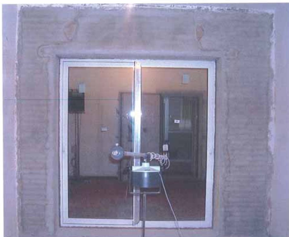
Fig.6 – Campione in prova: lato ricevente.
