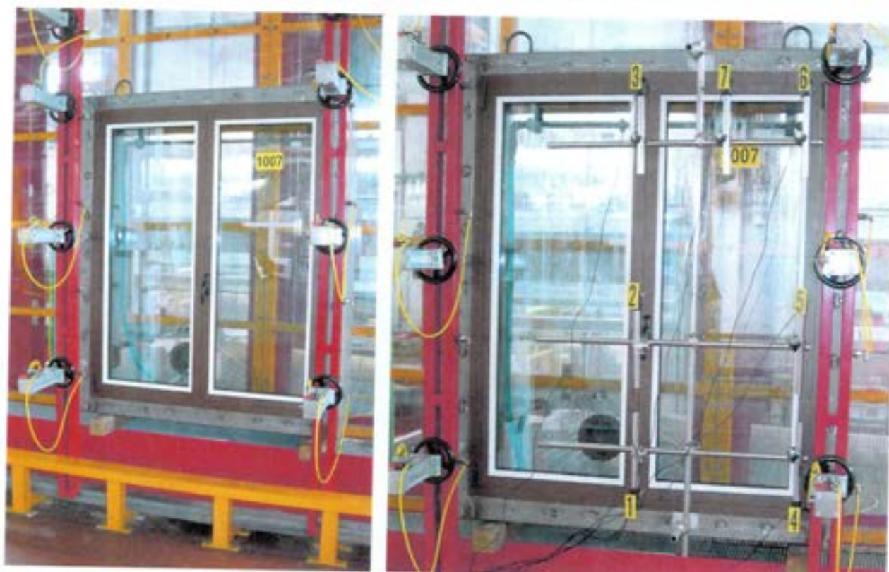
Foto 1 e 2: Campione pervenuto e sottoposto a prova nell'assetto sperimentale e durante i test di resistenza al vento (prova di deformazione)
