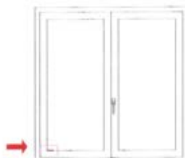
Fig. 4: Schema delle infiltrazioni riscontrate durante la prova di tenuta all'acqua a 1200 Pa
