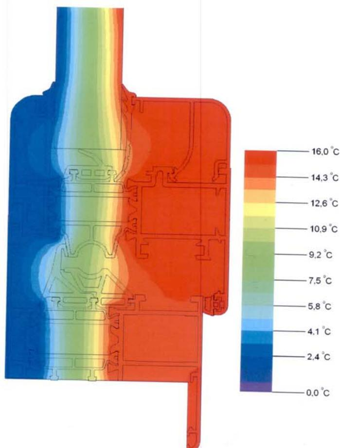
Fig. 2. Andamento delle temperature all'interno del profilo analizzato
