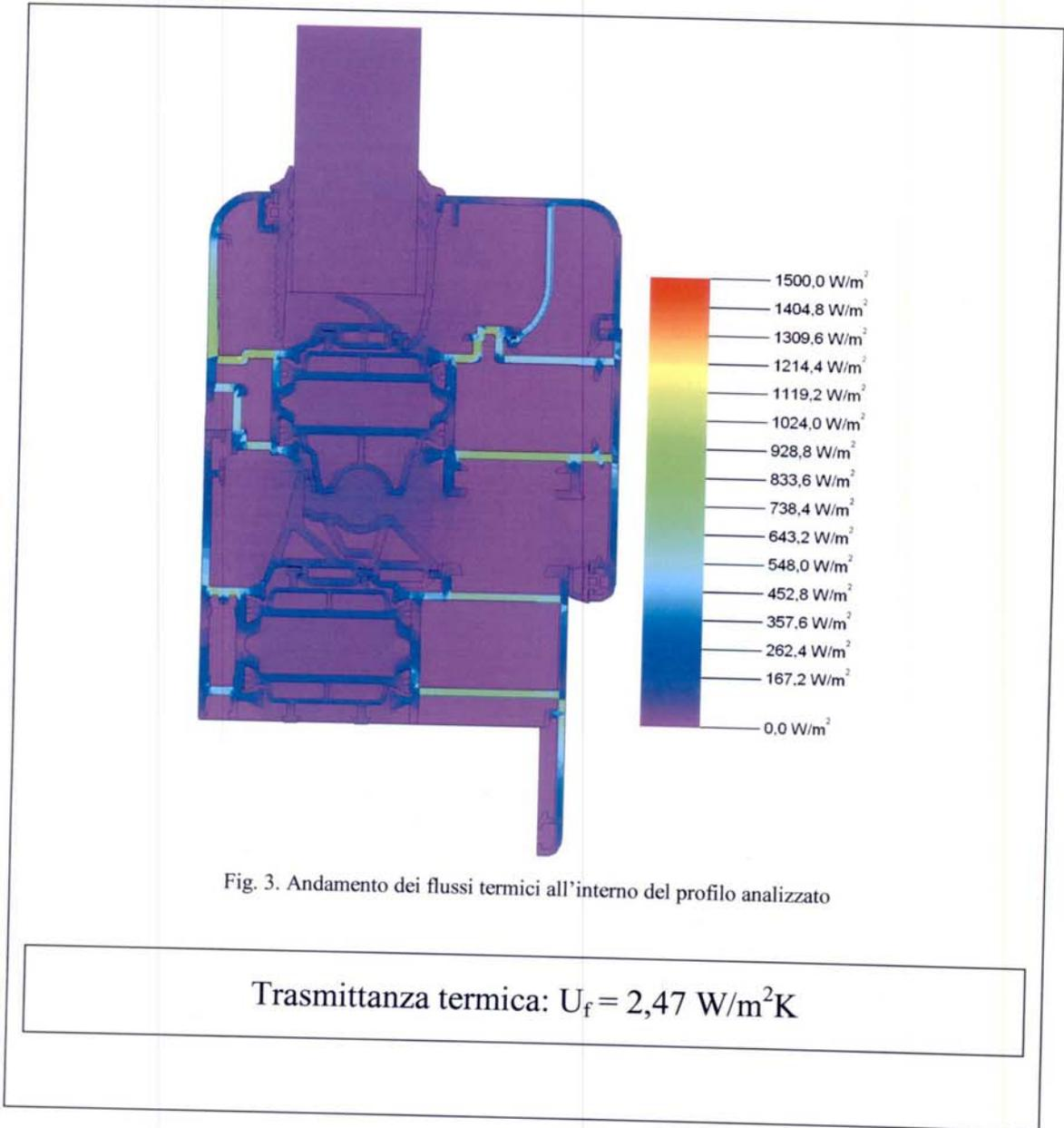
Fig. 3. Andamento dei flussi termici all'interno del profilo analizzato
