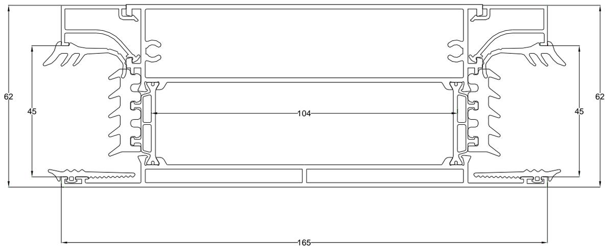
Fig. 29: Nodo traverso fisso con fermavetro “6140” appartenente alla Retta 12
