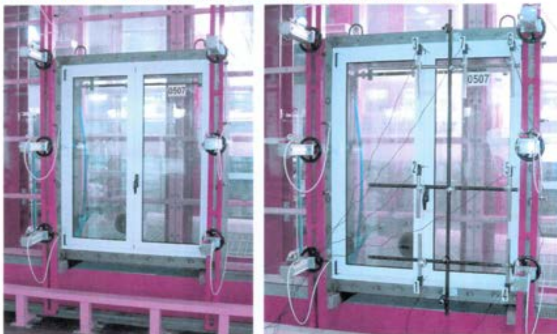
Foto 1 e 2: Campione pervenuto e sottoposto a prova nell'assetto sperimentale e durante i test di resistenza al vento (prova di deformazione)
