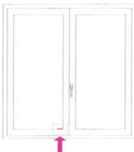
Fig. 4: Schema delle infiltrazioni riscontrate durante la prova di tenuta all'acqua a 750 Pa
