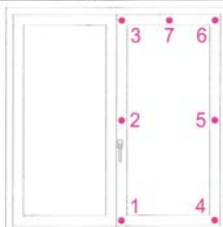
Fig. 5: Assetto sperimentale prova di resistenza al carico del vento: schema di posizionamento dei trasduttori (vista interna)
