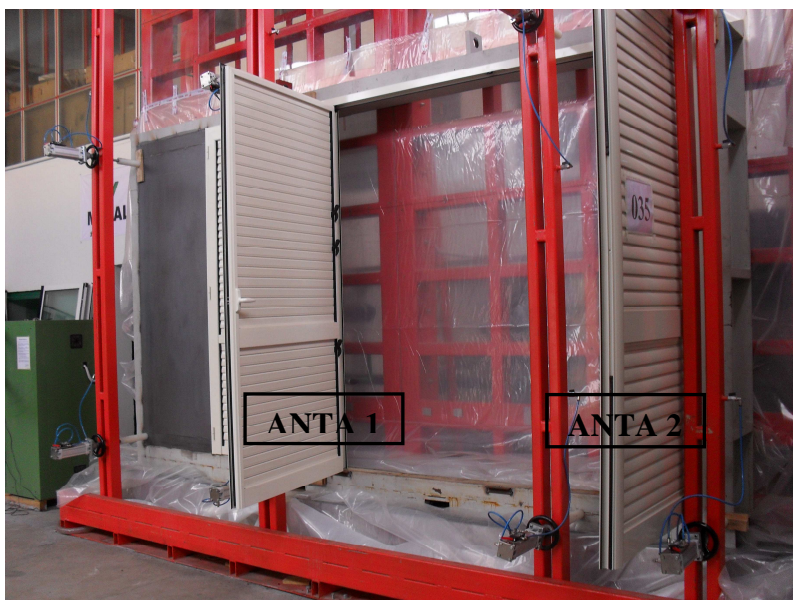
Foto 1 e 2: Campione sottoposto a prova nell'assetto sperimentale e dopo le prove di resistenza al carico del vento (carico di sicurezza diretto F_S e carico di sicurezza inverso -F_S )
