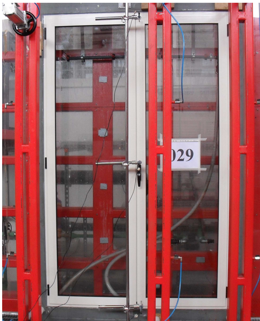
Foto 2: Campione sottoposto a prova durante i test di resistenza al carico del vento (prova di deformazione a pressioni positive e negative)
