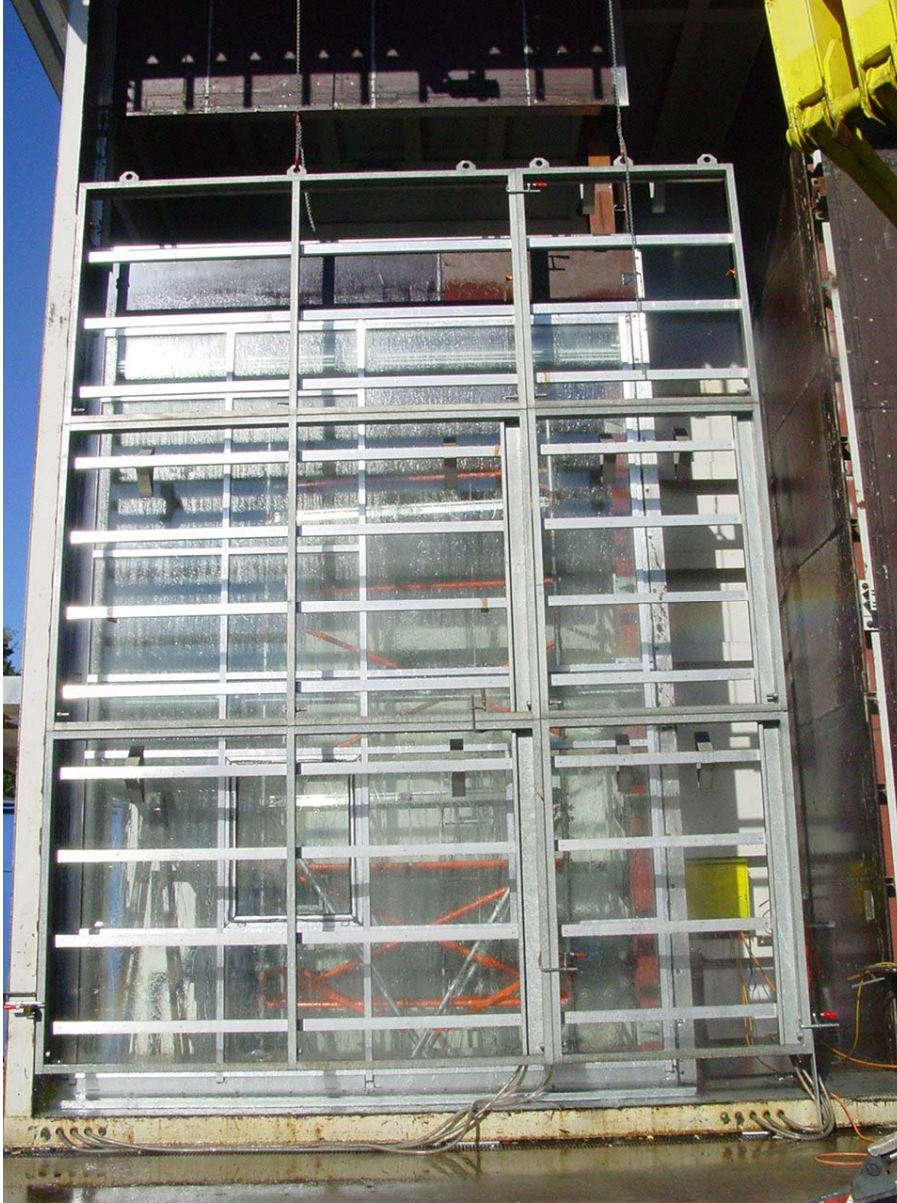
Bild 2 Fassade mit vorgehängtem Sprühraster zur Schlagregenbeanspruchung
