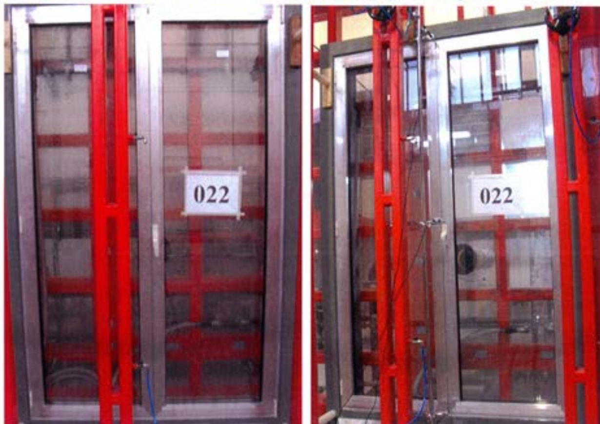
Photos 1 et 2 : Échantillon soumis à l'essai dans l'agencement expérimental et pendant les tests de résistance à la charge du vent (essai de déformations aux pressions positives et négatives)
